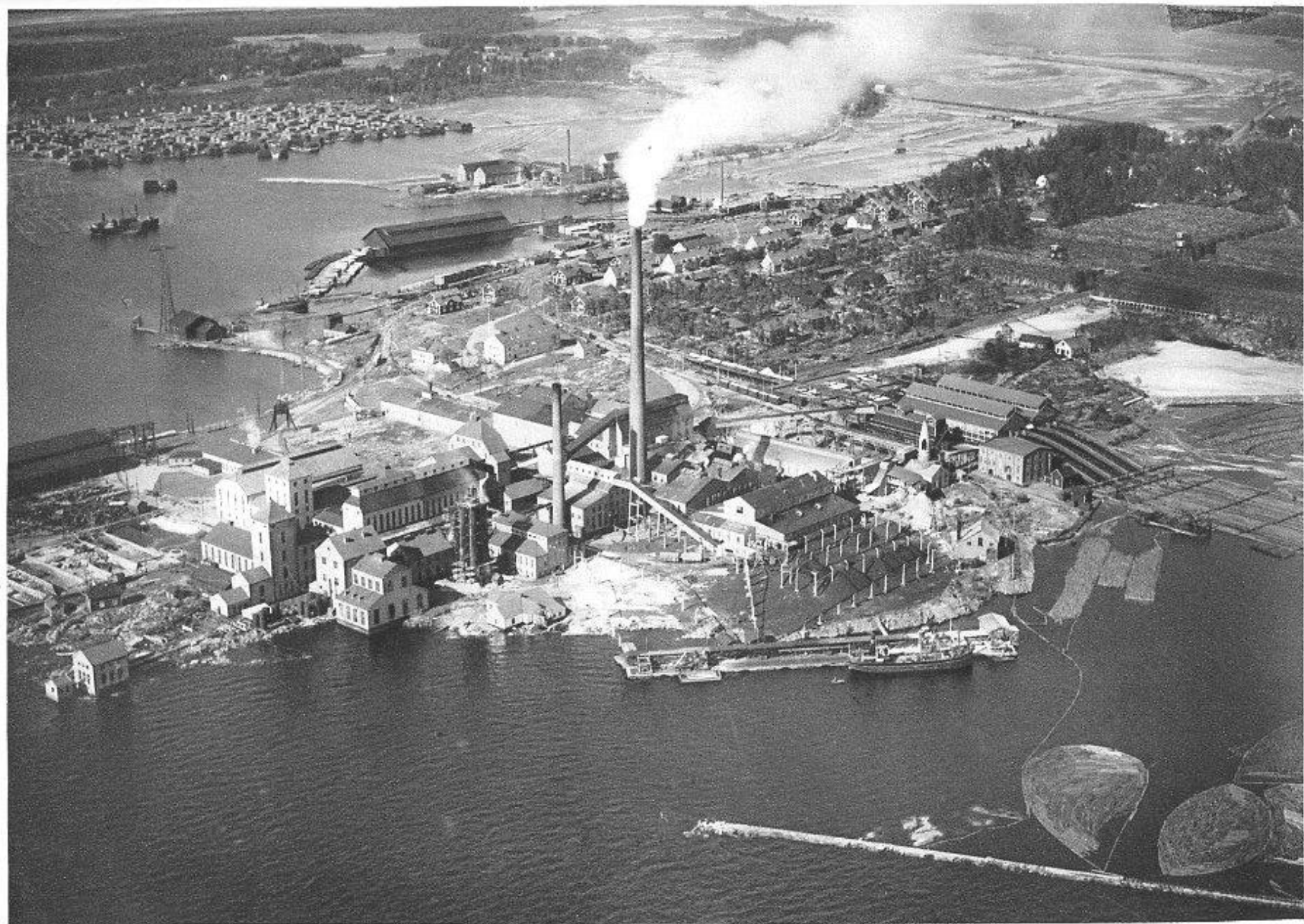
Skoghallsverken vid Klarälvens utlopp i Vänern är en mönsteranläggning, där träindustriens snart sagt alla grenar, elektriskt sågverk, sulfittfabrik, sulfatfabrik, sulfitspritfabrik, elektrokemisk fabrik etc., finnas sammanförda, och där stora hamnanläggningar möjliggöra direkt utförsel med oceangående fartyg (efter Trollhätte kanals senaste utvidgning). Foto: Aero-Materiel (1949).
