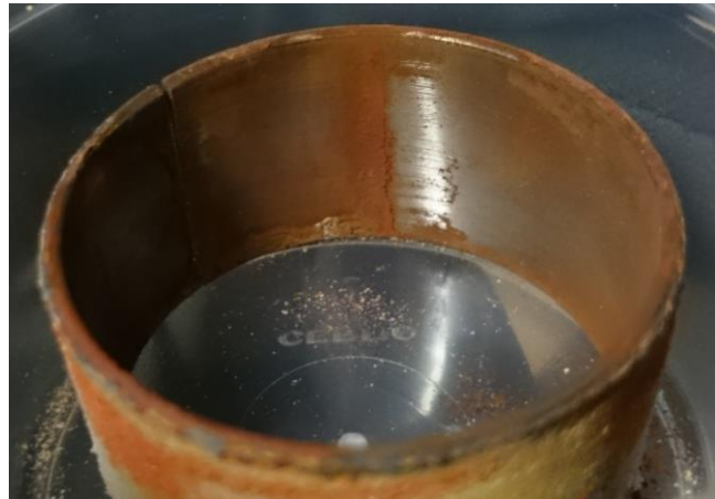
Figur 28 Insidan av sondringen som höll 75^\circ\text{C} under långtidsförsöket
