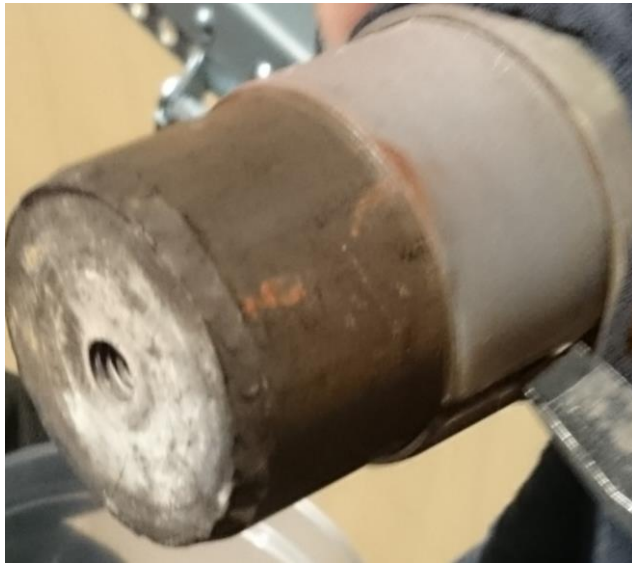
Figur 21 Utsidan av sondringen som höll 125°C under långtidsförsöket
