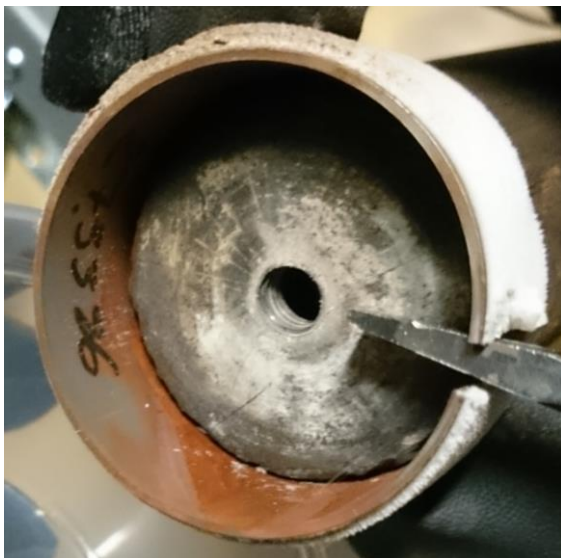
Figur 24 Utsidan av sondringen som höll knappt 100°C under långtidsförsöket
