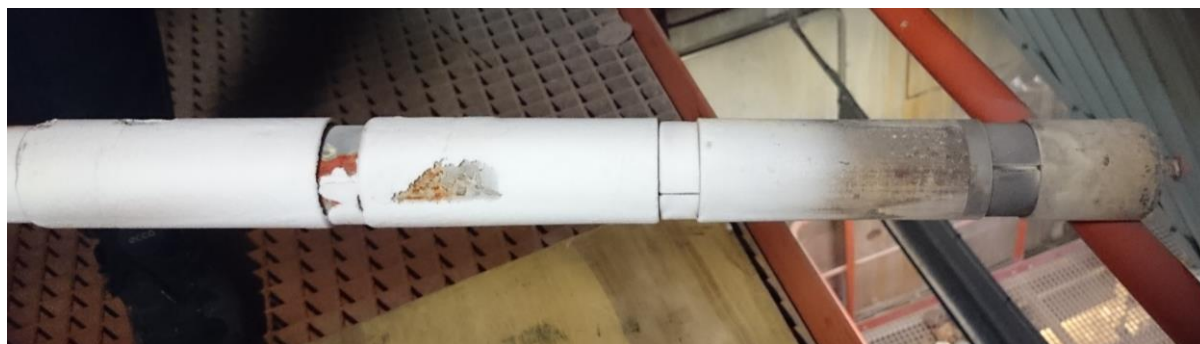
Figur 20 Korrosionssonden efter långtidstestet. De tre sondringarna var 125, 100 och 75°C respektive, räknat från höger.
