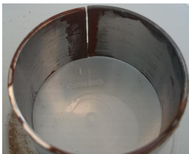
Figur 17 Insidan av sondringen som höll 75°C under korttidsförsöket
