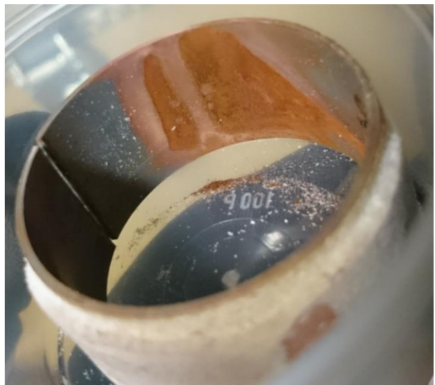
Figur 25 Insidan av sondringen som höll knappt 100°C under
