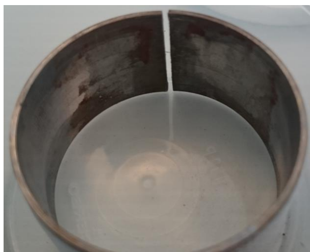
Figur 15 Insidan av sondringen som höll 100°C under korttidsförsöket
