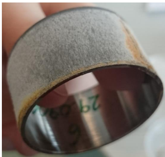
Figur 14 Utsidan av sondringen som höll 100°C under korttidsförsöket
