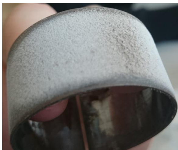
Figur 16 Utsidan av sondringen som höll 75°C under korttidsförsöket
