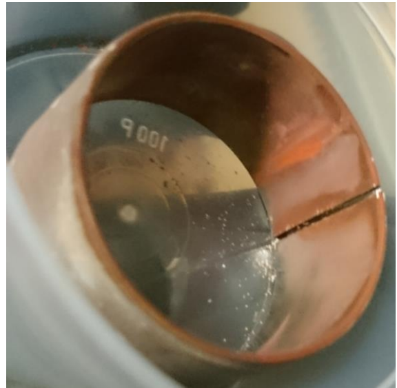
Figur 22 Insidan av sondringen som höll 125°C under långtidsförsöket
