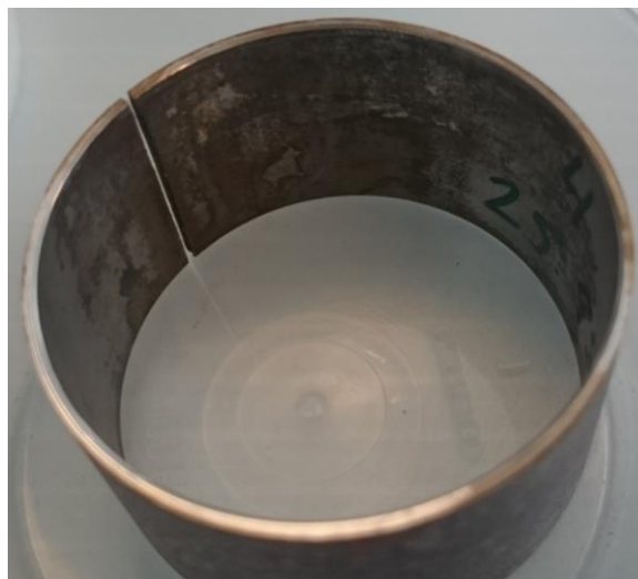
Figur 13 Insidan av sondringen som höll 125°C under korttidsförsöket
