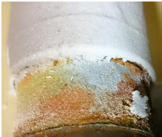
Figur 27 Utsidan av sondringen som höll 75^\circ\text{C} under långtidsförsöket
