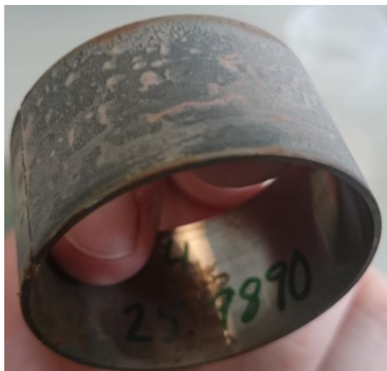
Figur 12 Utsidan av sondringen som höll 125°C under korttidsförsöket
