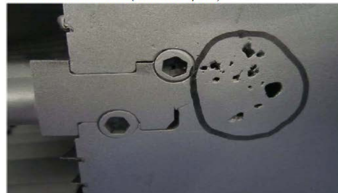
Bild / pict. 10 Detail / detail Pos.5 Lunkenfeld Ø 25mm mit Einzelanzeigen 1-5mm blow hole Ø 25mm with single indications 1-5mm
