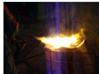
Olja med 45% lignin under förbränningsprov
